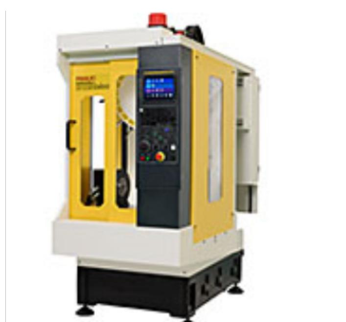
小型加工中心的分类：常按主轴在空间所处的状态分为立式加工中心和卧式加工中心，加工中心的主轴在空间处于垂直状态的称为立式加工中心，主轴在空间处于水平状态的称为卧式
